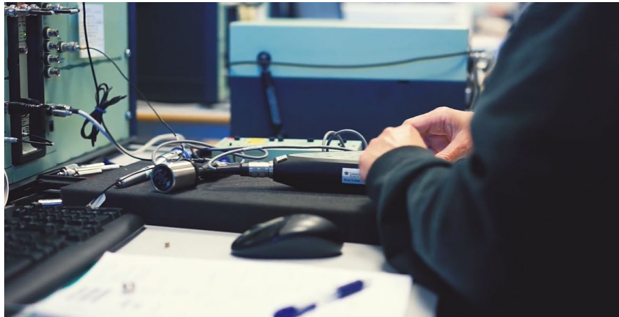
Figure 28 Vérification périodique des instruments de mesure du bruit en laboratoire ou par le fabricant
